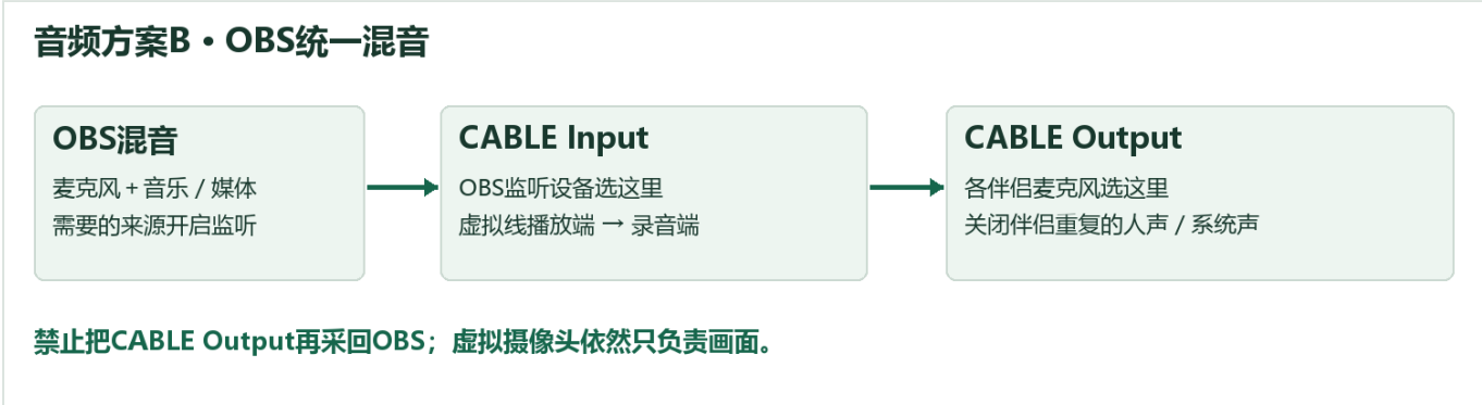
图3：Input是送入虚拟线的播放端，Output是伴侣读取的录音端，名称不要反选。
