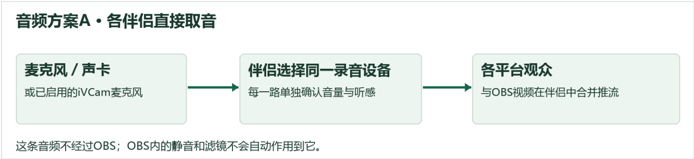
图2：音频绕过OBS。OBS内麦克风静音、滤镜或音量调整不会控制这条直接音频链路。
